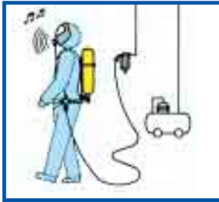
Alimentazione della linea Feeding from air line
